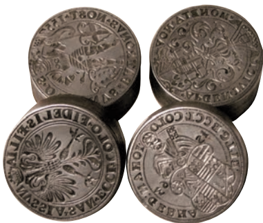
Штемпели для чеканки подделок, изготовленные ручной гравировкой.
